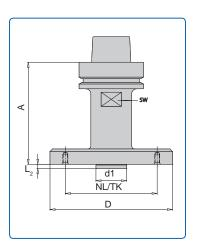
Anwendung: | Aufnehmen eines Sägeblatts
