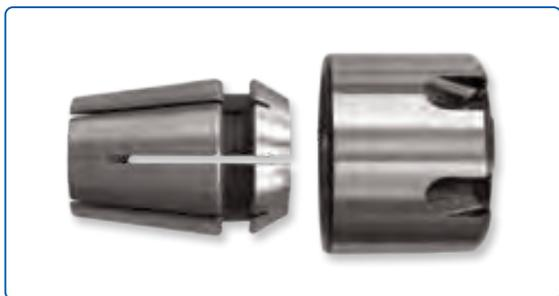
Die ER16-Spannzangen der folgenden Sets sind sehr dünnwandig und können bei der Montage irreparabel verbogen werden. Mit dem Kauf eines Sets erhalten Sie eine fachgerecht in die Spannmutter eingesetzte Spannzange. Beschädigungen werden so vermieden. Die eingesetzte Spannzange kann später nicht mehr ohne Schaden aus der Minimutter entfernt werden.
