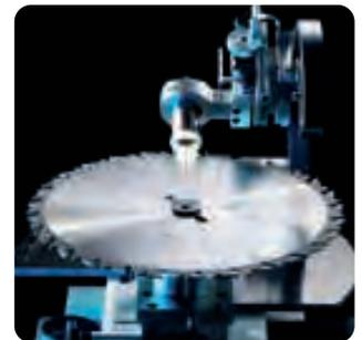
Der Real-Time-Analyser (= RTA) ist ein System zur professionellen Werkzeugvisualisierung gepaart mit einer hochwertigen optischen Messeinheit. Seine modulare Bauweise ermöglicht die Analyse der unterschiedlichsten Werkzeuge. Mit dem RTA lässt sich alles visualisieren, was unter die Lupe passt.
