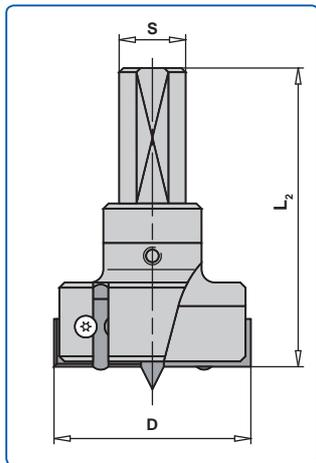
Anwendung: Bohren maßhaltiger und ausrissfreier Sacklöcher in allen gängigen Plattenwerkstoffen, sowie in Hart- und Weichholz (z. B. zur Aufnahme von Möbelbeschlägen)
