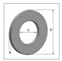
Zum Reduzieren der Bohrung bei Sägeblättern. Den Reduzierring breit genug wählen, um ein Verschieben des Ringes in die Flanschaussparung zu verhindern.
