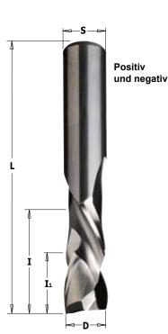
Hergestellt aus hochwertigem Feinstkornhartmetall haben diese Vollhartmetallfräser eine lange Lebensdauer und ermöglichen durch ihr feines und eng toleriertes Schliffbild feinste Kanten. Die Spiralform der Werkzeuge sorgt für einen sehr guten Spanauswurf sowie niedrige Arbeitstemperaturen.
