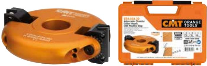
Dieser Schwenkmesserkopf ist zwischen -45° und +45° verstellbar. Zur komfortablen Winkeleinstellung verfügt er über Rasterpunkte alle 7,5°. Somit lässt sich der gewünschte Winkel besonders einfach und schnell einstellen.
