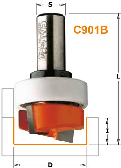
Diese Fräser haben zwei dicke Hartmetall-Schneiden, die sorgfältig abgestimmt wurden, um sowohl saubere Flanken, als auch einen glatten, ebenen Boden der Fräsung zu erzielen. Die speziellen negativen Schnittwinkel verhindern Ausrisse.
