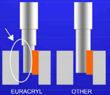
Wuchtfläche außerhalb des Fräsbereiches für mehr Laufruhe durch weniger Luftkompression
