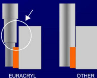
2. Durchmesserabstufung im Fräsbereich für mehr Raum für die Späne (feinpoliert)
