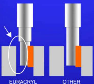
Wuchtfläche außerhalb des Fräsbereiches für mehr Laufruhe durch weniger Luftkompression
